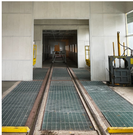
Камера порошковой окраски
