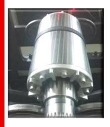
Каждый ротор проходит испытание на динамическую балансировку для определения центробежной инерционной силы и автоматического определения точки эксцентриковой массы для коррекции динамического баланса ротора.
