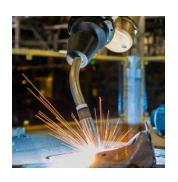
Автоматически производит сварку изделий, регулирует параметры сварки (напряжение, ток).
